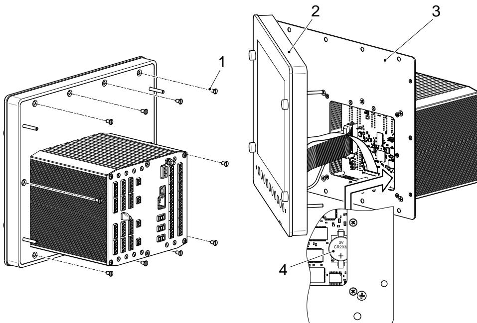
4.1.4.1.2 Соблюдая осторожность, разъединить переднюю (поз.2 ) и заднюю (поз. 3) части корпуса, не отсоединяя шлейф и кабели от передней части прибора.
