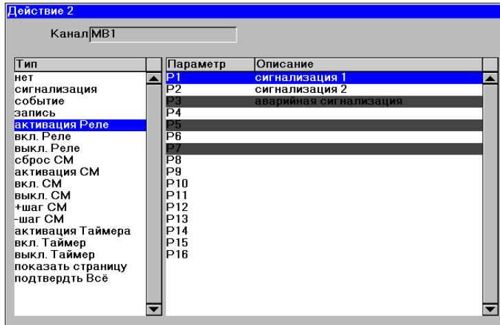
Выбор типа действия осуществляется клавишами **типа +** и **типа -**; выбор параметра – клавишами **канала +** и **канала -**. Выбранная позиция выделяется синим фоном. Для подтверждения ввода нажмите «**OK**», для отмены изменений – «**Отмена**».
