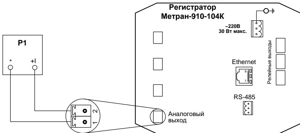
Рисунок В.5 – Схема подключения регистратора при определении основной погрешности воспроизведения токовых сигналов.
