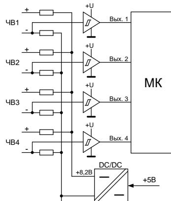
Рисунок 1.3. Структурная схема группы из 4-х частотно-импульсных входов
