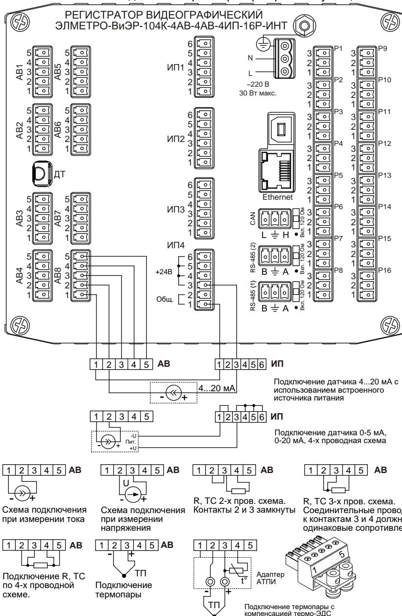
Рисунок Б.1 – Подключение датчиков к каналам АВ.
