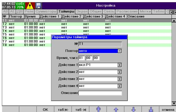
Рисунок 2.21 Конфигурирование таймера
