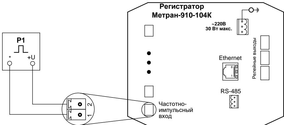
P1 – Генератор импульсов
