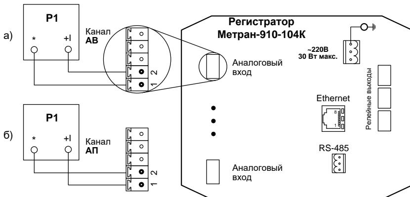
а) Схема подключения при измерении тока
