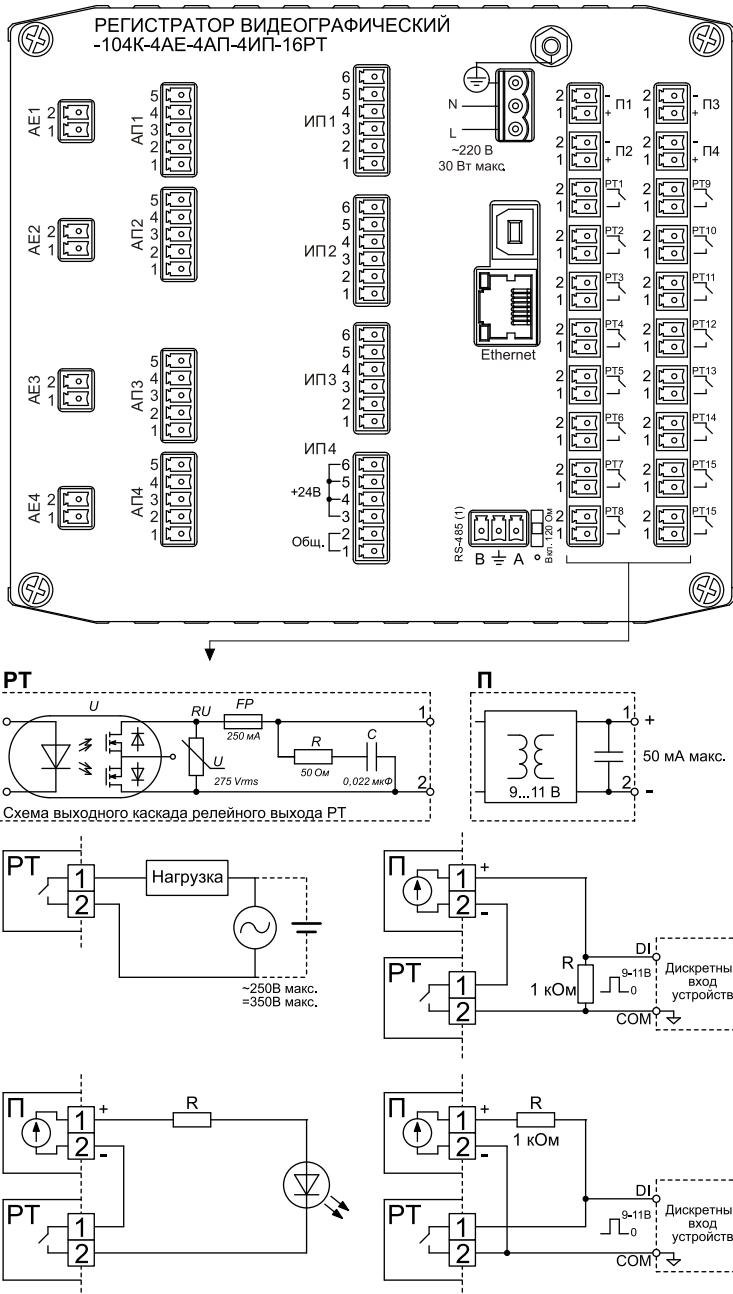
Рисунок Б.4 – Подключение выходов твердотельных реле (РТ).
