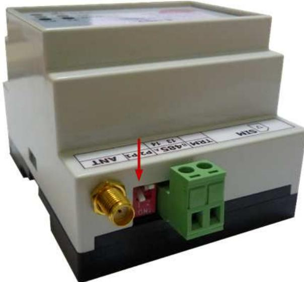
Рисунок 52. Установка движкового переключателя 1 в положение **ON**
