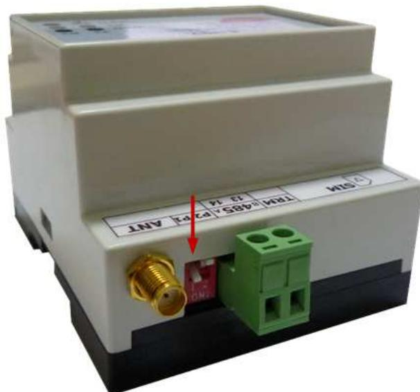
Рисунок 9. Установка движкового переключателя 1 в положение **ON**
