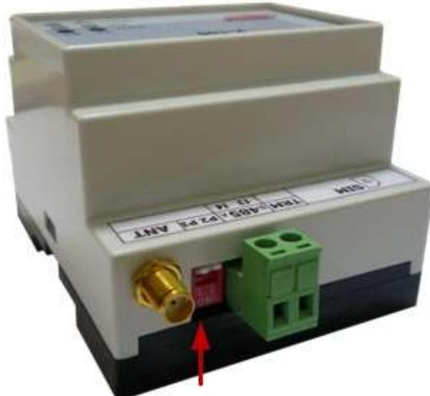
Рисунок 49. Установка движкового переключателя 1 в положение OFF
