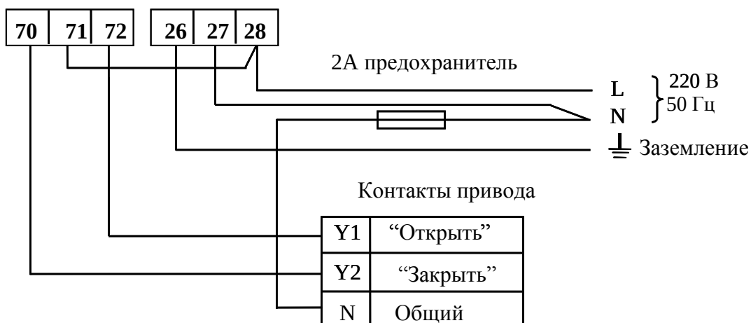
Рис Л.1. Схема подключения питания счетчика и регулирующего привода к модулю питания (напряжение управления 230 В)
